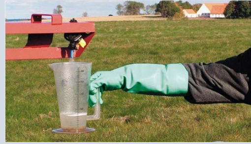
Şekil 2. Tarla pülverizatörlerinde meme verdisinin ölçümü
