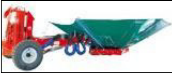
Şekil-5. Gövde sarsıcı hasat makinasına şemsiye takılması
