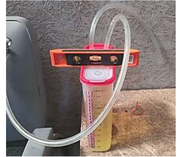
Resim 3. Yakıtmytik77 sisteminin genel görünüşü. Bu sistem; Bir adet depo, iki adet bağlantı borusu ile bağlantı elemanları ve bir adet su terazisinden oluşmaktadır
