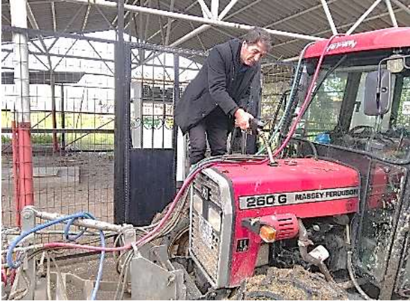
Resim 1. Tamamlama yöntemiyle yakıt tüketimi ölçümü
