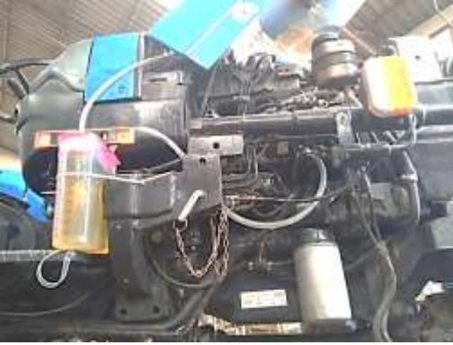
Resim 5. Yakıtmıyık77'nin traktöre bağlanması
