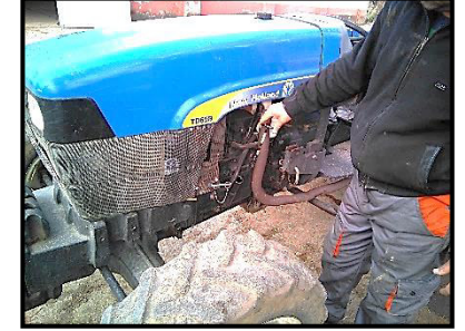
Şekil 4. Traktörde yağ kontrolü
