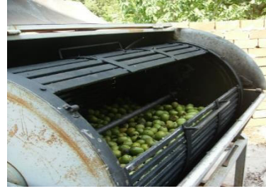
Yeşil kabuklu ceviz meyvesinin soyma makinasına doldurulması
