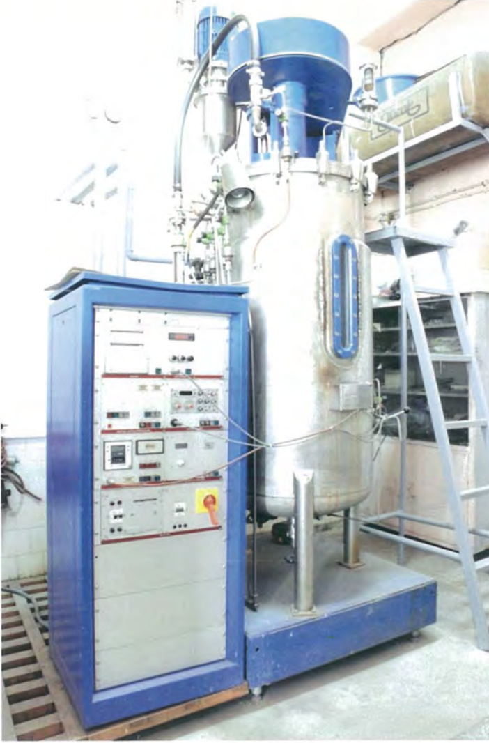
Şekil 7. Sıvı kültürün üretildiği fermantör
