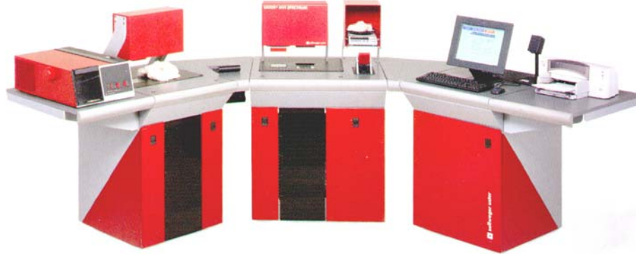
Şekil 1. HVI 900 Pamuk test cihazı (Zellweger Uster, 2000/2001).
