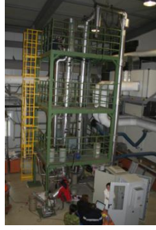
Şekil 14. Lab DAY sistemi (30 kWth)
