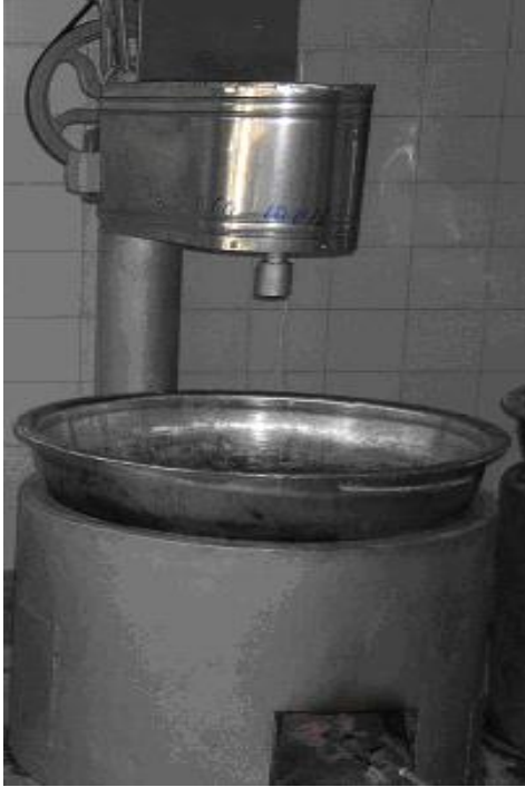
Şekil A: Lokum Pişirme Kazanı.
