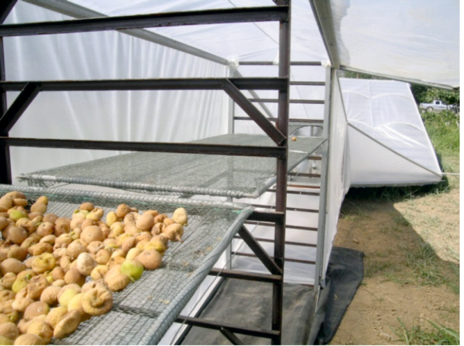
Şekil 9. Güneş kollektörlü sistemde kurutma
