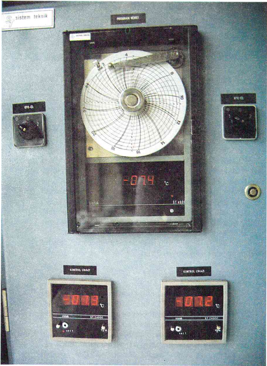
Resim.12. Don testlerinde kullanılan program verici
