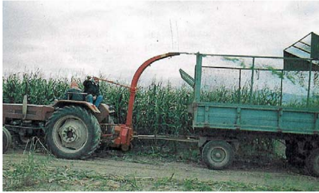
Resim 1. Tek sıra biçen mısır silaj makinesi.
