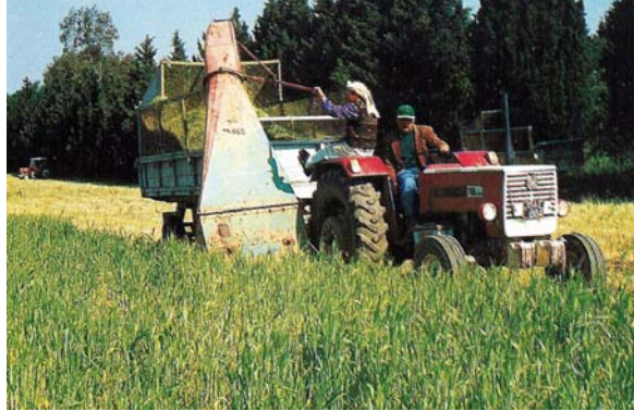
Resim 3. Vurmalı tip ot silaj makinesi.
