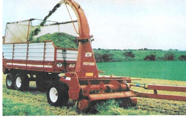
Resim 4. Toplayıcı- kıyıcı ot silaj makinesi.
