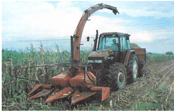
Resim 2. Çok sıralı mısır silaj makinesi.
