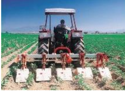
Şekil 4. Frezeli araçpa makinası
