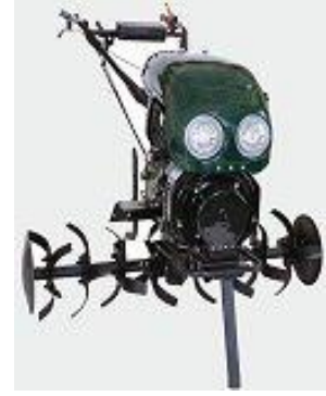
Şekil 6. Motorlu toprak frezesi
