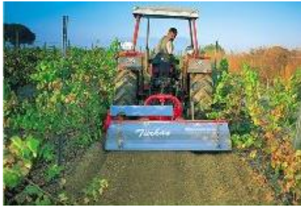
Şekil 5. Kaydırmalı toprak frezesi
