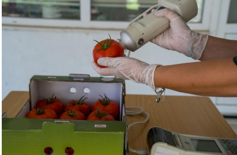
Şekil 10. Otomatik Renk Ölçer Yardımı ile Meyve Kabuk Rengi Saptanması
