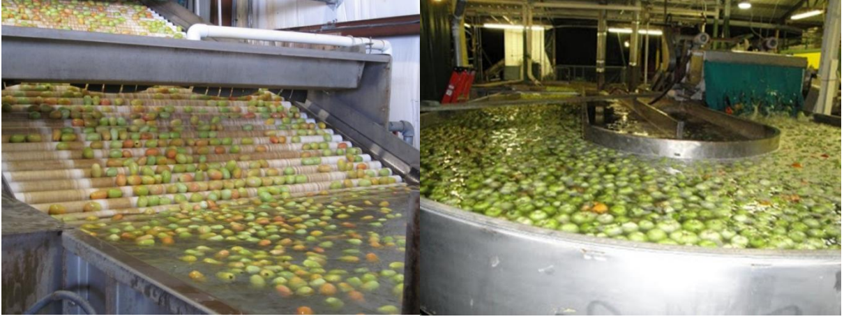
Şekil 21. Yıkama Tankı (100-150 ppm Klorin)
