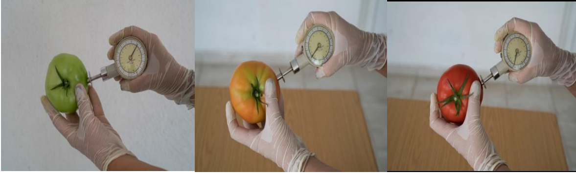
Şekil 15. Farklı olum dönemlerinde domateslerde el penetrometresi yardımıyla meyve eti sertliğinin ölçülmesi
