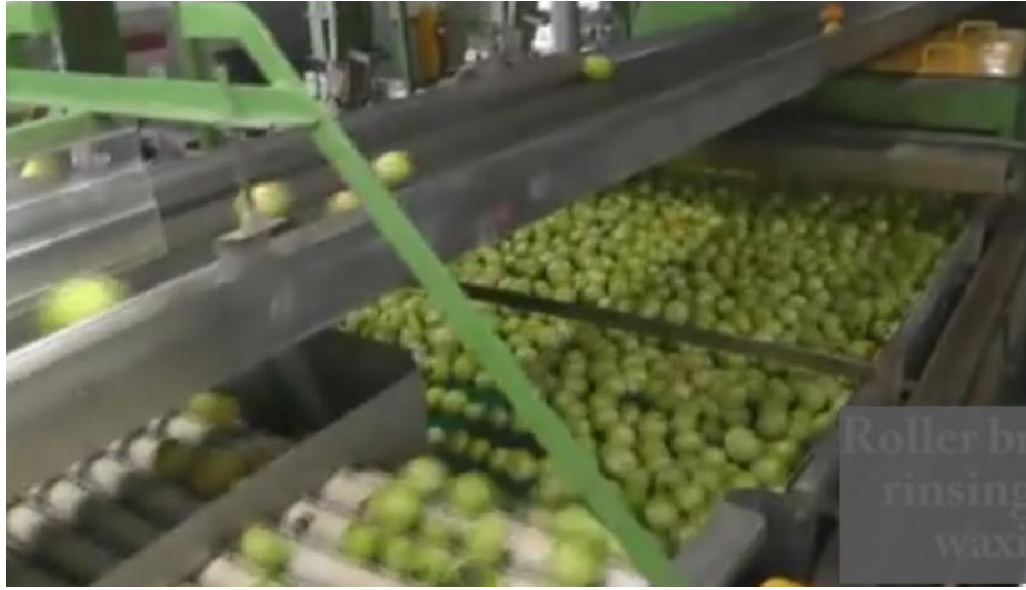
Şekil 22. Fırçalama, Durulama, Kurutma /Mumlama (Carnauba, Shelac), Mumlama+Fungusit (SOPP/ Potasyum Sorbat)
