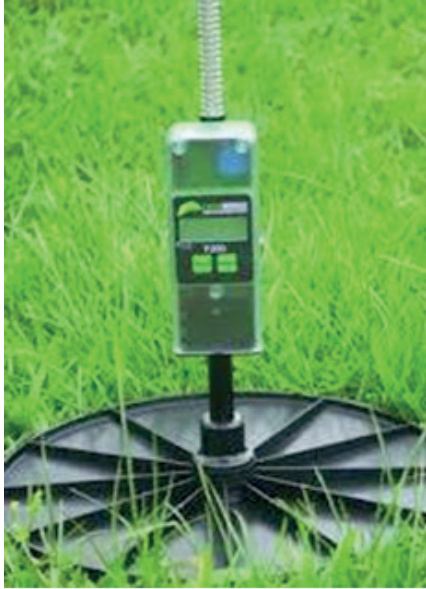
Şekil 10. Vejetasyon parametrelerine göre dolaylı yöntem. Sol: Elektronik ölçüm diski, çim yüksekliğini ve yoğunluğunu “sıkıştırılmış yem yüksekliği” adı verilen tek bir ölçümde birleştiren bir cihaz. Sağ: Manor Farm’da plaka-metre yöntemi ile hesaplanan kuru madde ile kesim-plot yöntemi arasındaki karşılaştırma
