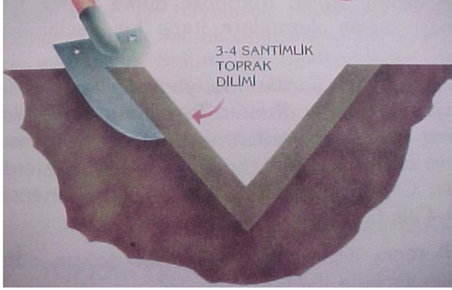
Şekil 2. Toprak Numunesi Alınırken “V” Harfi Şeklinde Çukur Kazılması
