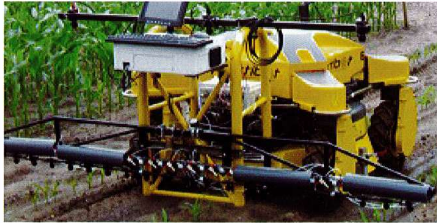
Şekil : Görüntü işleme teknolojisi ile ilaçlama
