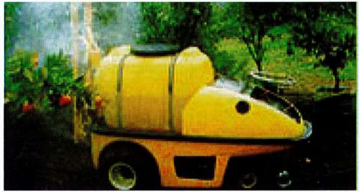
Şekil : Meyve bahçesi ilaçlama robotu
