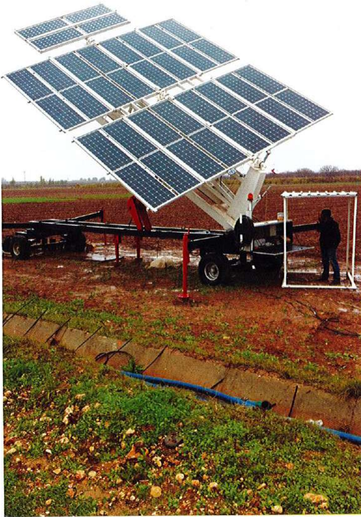
Sulama sistemleri için tasarlanan güneş paneli
