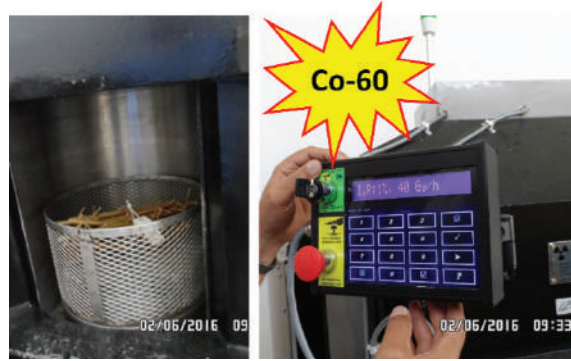
Şekil 4. Aşı kalemlerine radyasyon uygulaması
