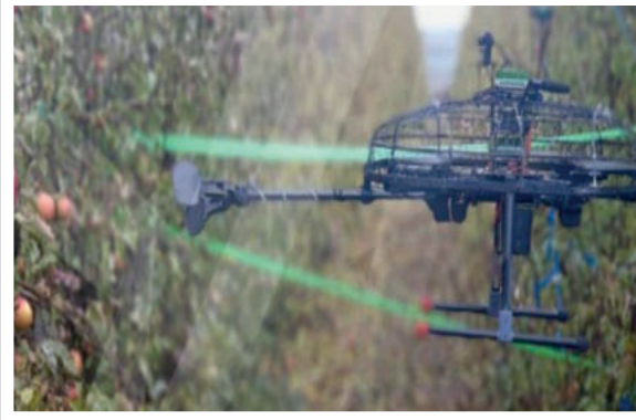
Şekil 3. Otonom Hasat Toplama Hava Aracı
