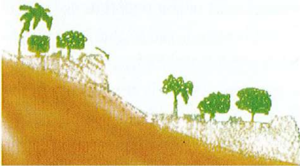
Su hasadı tekniklerinden biri olan, Jessour nispeten dik vadilerde eğim boyunca inşa edilen duvarları tanımlayan Arapça bir terimdir. Uzun yıllar boyunca yüzey akışa geçen su, inşa edilen duvarların arkasında durdurulduğu için sedimentler çöküp birikmekte su ve toprak erozyonunu önlemenin yanı sıra bu uygulama ile tarım için elverişli toprak elde edilmektedir.
